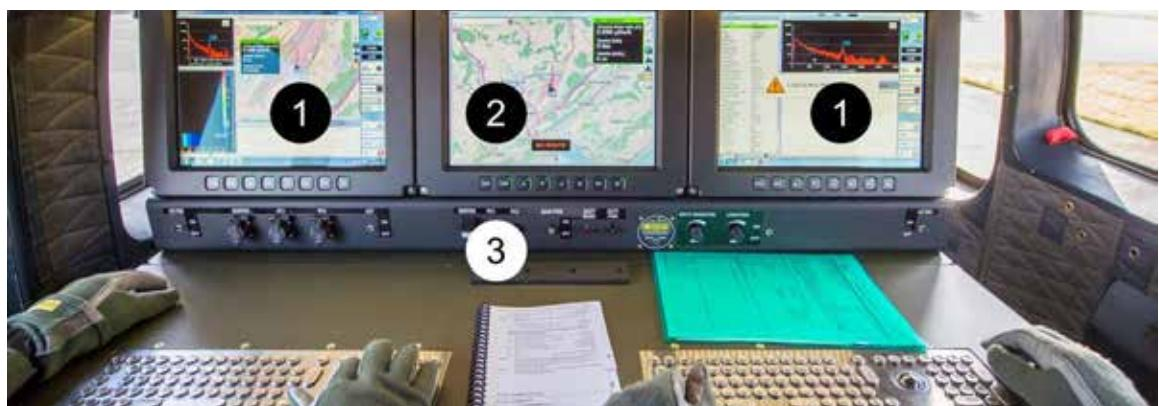
Abbildung 2: Operateur-Konsole des Aeroradiometriesystems.
