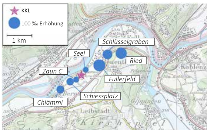
Figur 2: Netto \Delta^{14}\text{C} -Messwerte in der Umgebung des Siedewasserreaktors Leibstadt (KKL) im Jahr 2019. Revisionsabschaltung: 03.06.19 bis 03.07.19. Probenahme: 27.05.19 und 16.09.19. Dargestellt sind die jeweils höchsten Messwerte beider Messungen. Die Kreisflächen sind proportional zur Erhöhung gegenüber den unbelasteten Referenzstationen.
