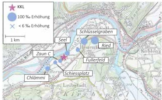
**Figur 2:** Netto  $\Delta^{14}\text{C}$ -Messwerte in der Umgebung des Siedewasserreaktors Leibstadt (KKL) im Jahr 2021. Revisionsabschaltung: 24.06.2021 bis 05.12.2021. Probenahme: 22.06.2021 (KUP) bzw. 15.09.2021 (LARA). Die Kreisflächen sind proportional zur Erhöhung gegenüber den unbelasteten Referenzstationen.
